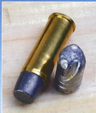
Före och efter. Kulan, som hittades under skinnnet efter djup penetration, har roterat mot bogbladet utan att splittras, vilket visar vikten av bra legering. Kulorna, som väger 335 grains, har en mix av 92 % bly, 6 % antimon och 2 % tenn, om nu någon vill gjuta egna blydagg.
